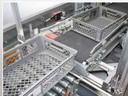
Nakládací sekce portálové zdviže s transferem na plnicí dopravník, který zajišťuje oddělení jednotlivých dopravovaných kusů
