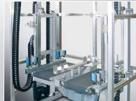
Jako varianta může být zdviž osazena dvojitým dopravníkem
