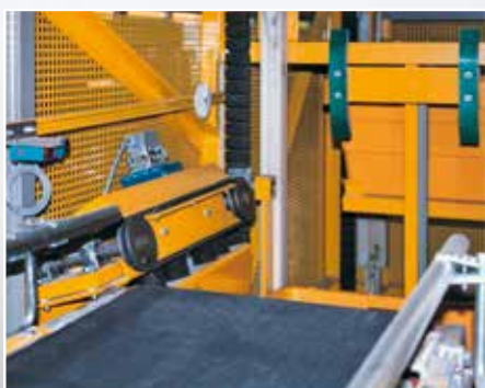
Pro jednotky stejných rozměrů jsou plošinky vetknuty do gumových řetězů a běží ve vodících plastových kolejnicích po celém obvodu dopravníku, což zajišťuje hladký chod bez vibrací.
