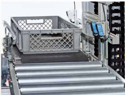
Transfer z pásového dopravníku zdviže na navazující válečkový dopravník
