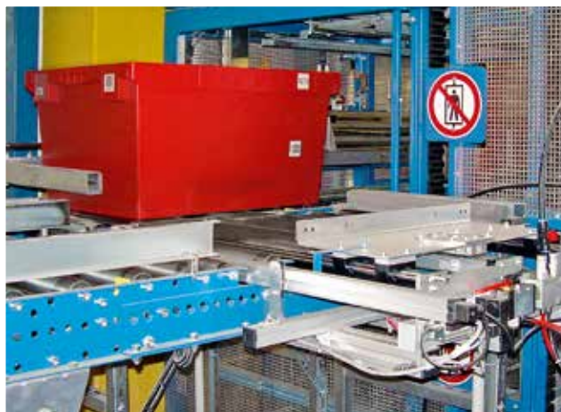
Nakládací stanice indexačního dopravníku pro plastové boxy
