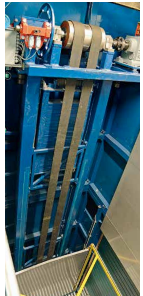
Pohon těžké řady zdviže s motorem, převodovkou, spojkou, hnacím bubnem a bezpečnostním zámkem polohy
