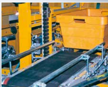
Pro jednotky stejných rozměrů jsou plošinky vetknuty do gumových řetězů a běží ve vodících plastových kolejnicích po celém obvodu dopravníku, což zajišťuje hladký chod bez vibrací.
