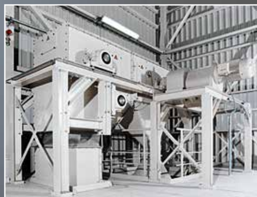
Výsypná sekce dopravníku WB640 s 30kW motorem
