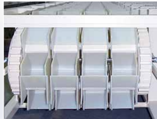
Dělený korečkový pás na napínací jednotce
