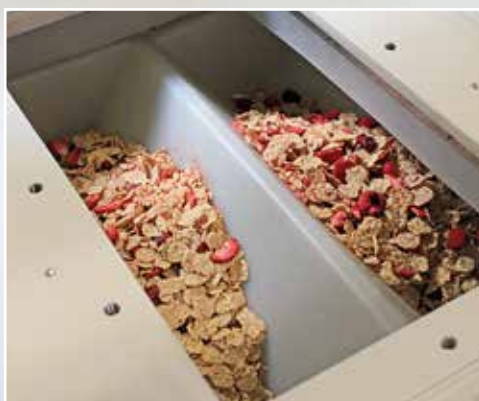
Plnicí místo se silikonovým těsněním
