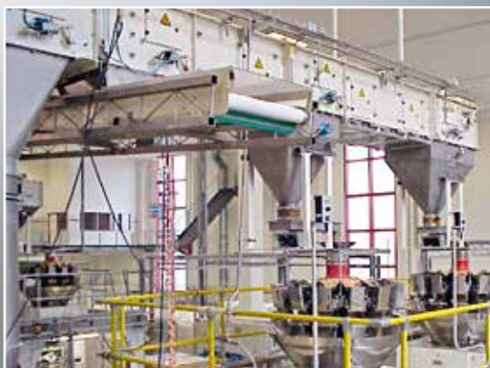
Kyvný korečkový dopravník může mít libovolný počet výsypů
